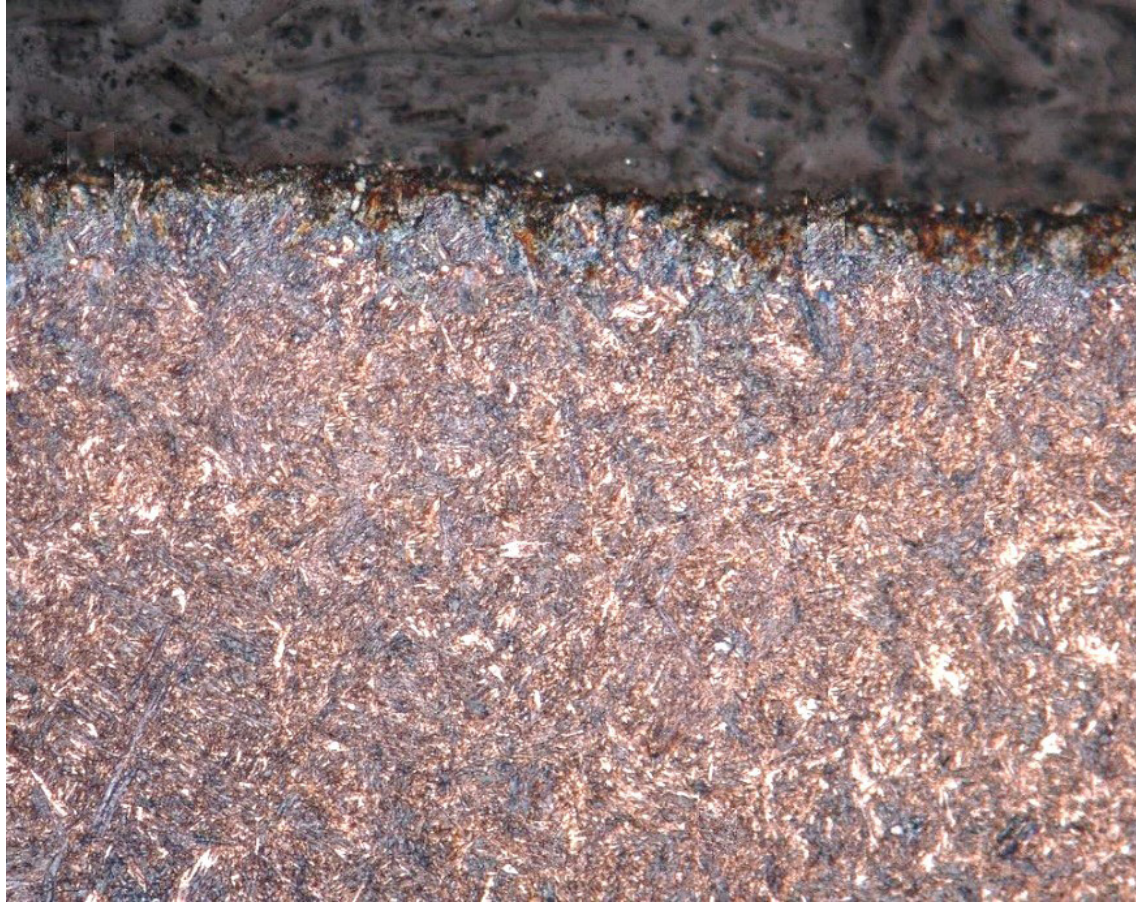
Microstruttura di uno strato cementato acciaio 18NiCrMo5_500X (gentile concessione dell'azienda Franisa Tempra Acciai Speciali srl)
